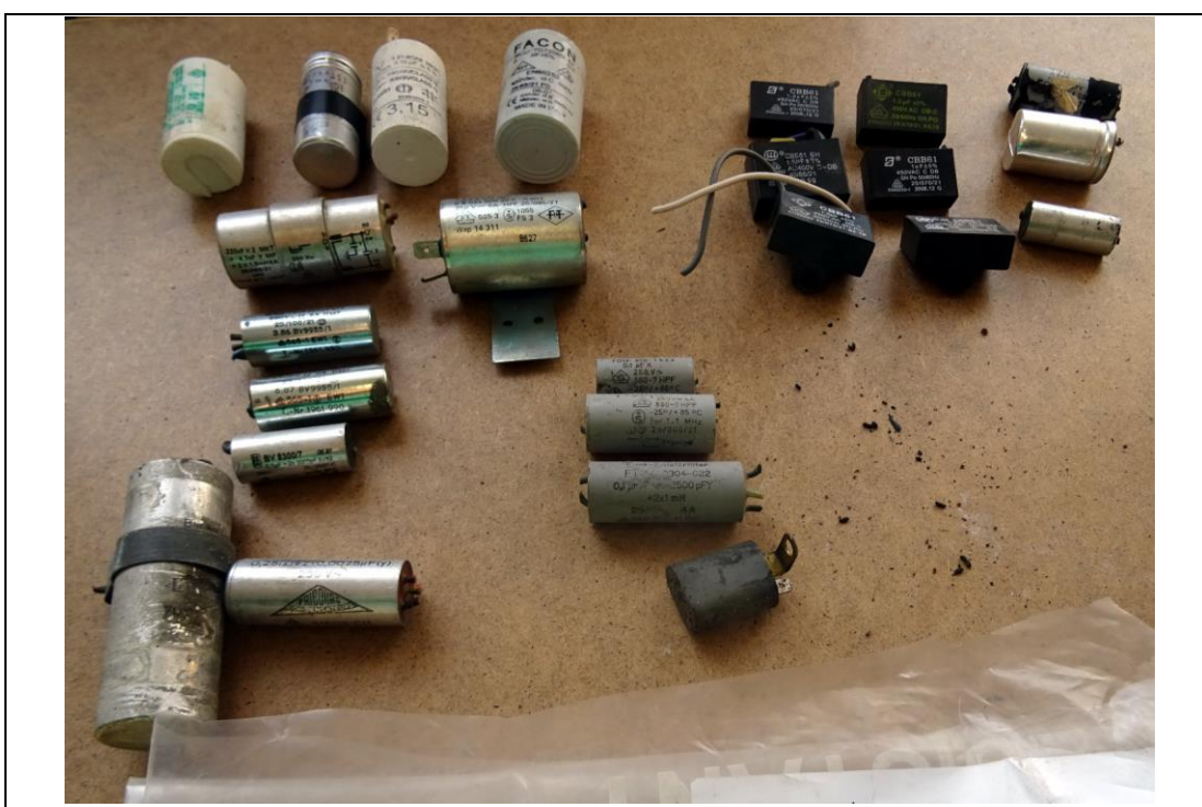
Abbildung 17: Ein Teil der gesammelten Kondensatoren aus Haushaltskleingeräten
