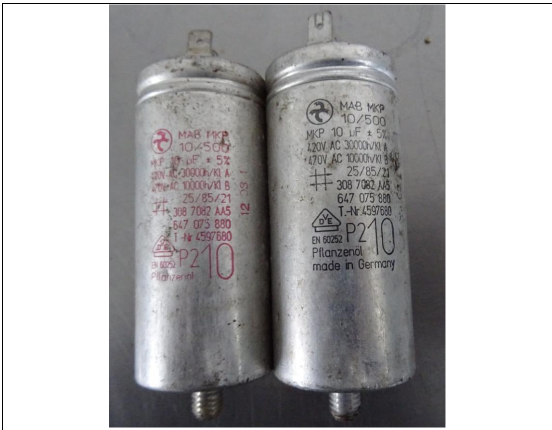
Abbildung 4: Beispiel zweier Kondensatoren mit Modellbezeichnung MAB MKP 10/500
