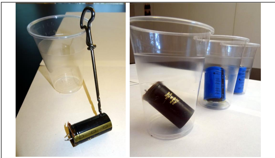
Abbildung 12: Anstechen des Elkos und trockene Behälter nach 13 Tagen Versuchsdauer
