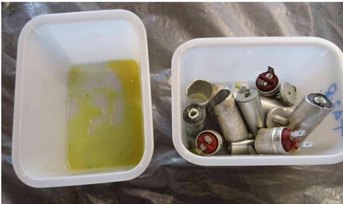
Abbildung 15: Separierte Probe des Kondensatormodells Nr. 109
