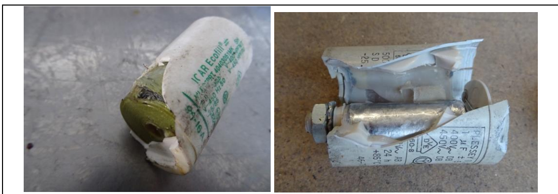
Abbildung 21: Geöffneter KS-Kondensator ohne flüssige Inhaltsstoffe
