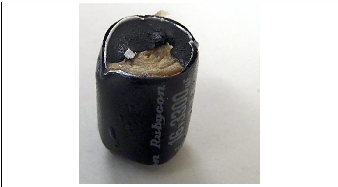
Abbildung 13: Aluminium-Elko, Deckel entfernt. Blick auf Bitumensiegel und Wickel
