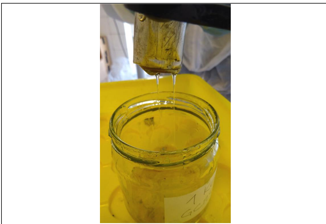
Abbildung 11: Flüssigkeitsaustritt aus ungepoltem zylindrischem Kondensator nach dem Aufschneiden
