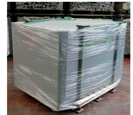
Photo 3: cette forme de livraison est désormais conforme à l'ADR.
