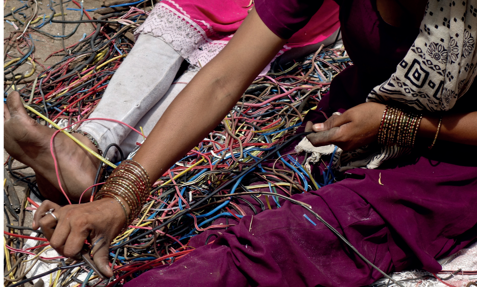
Photo 1: épluchage de câbles et tri par couleurs de fractions dans le secteur informel à Delhi en Inde.
