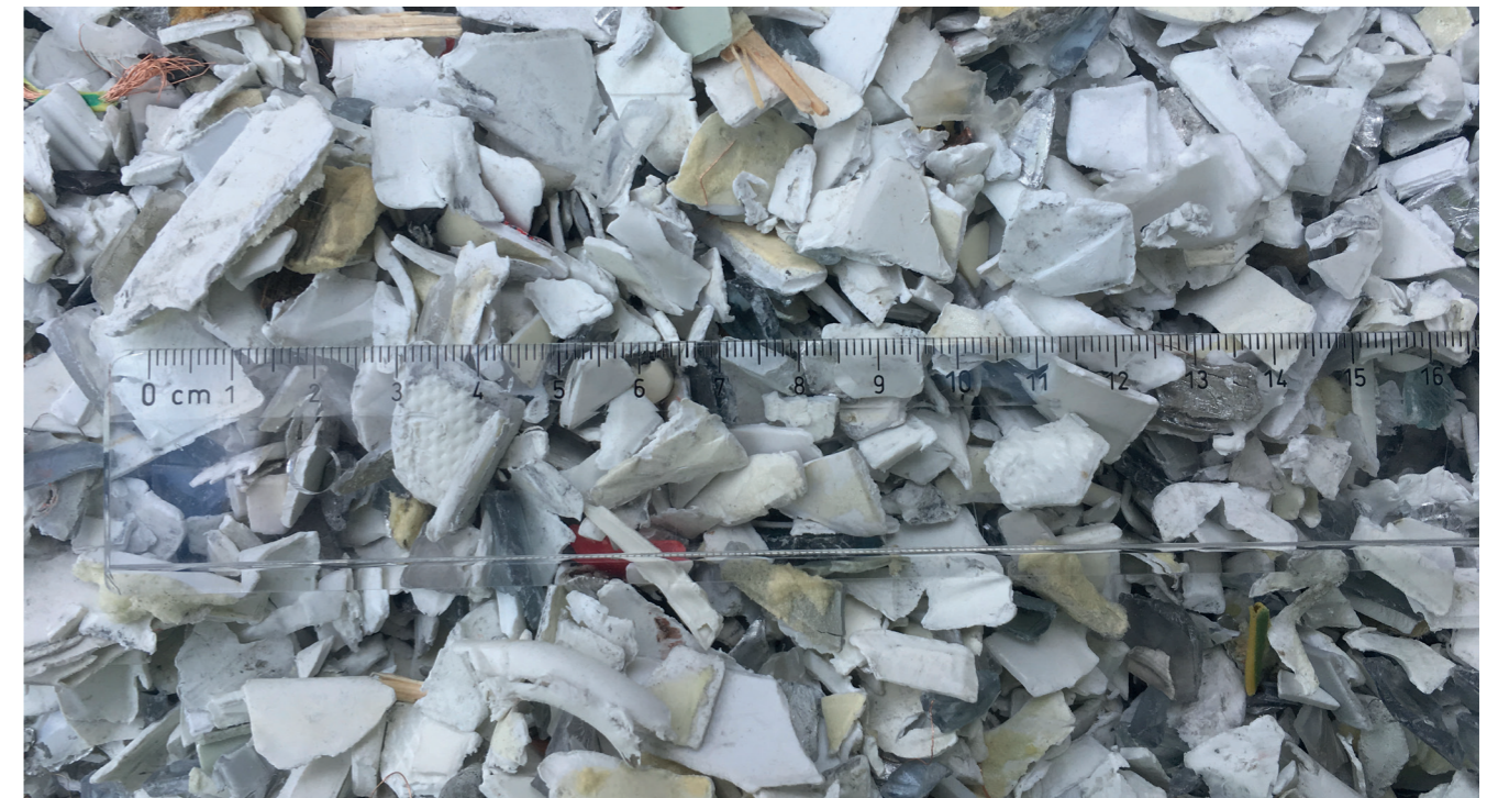
Photos 2 et 3: échantillonnage de matières plastiques issues de gros appareils électroménagers en vue de déterminer la teneur en polluants (photos: Arthur Haarman).
