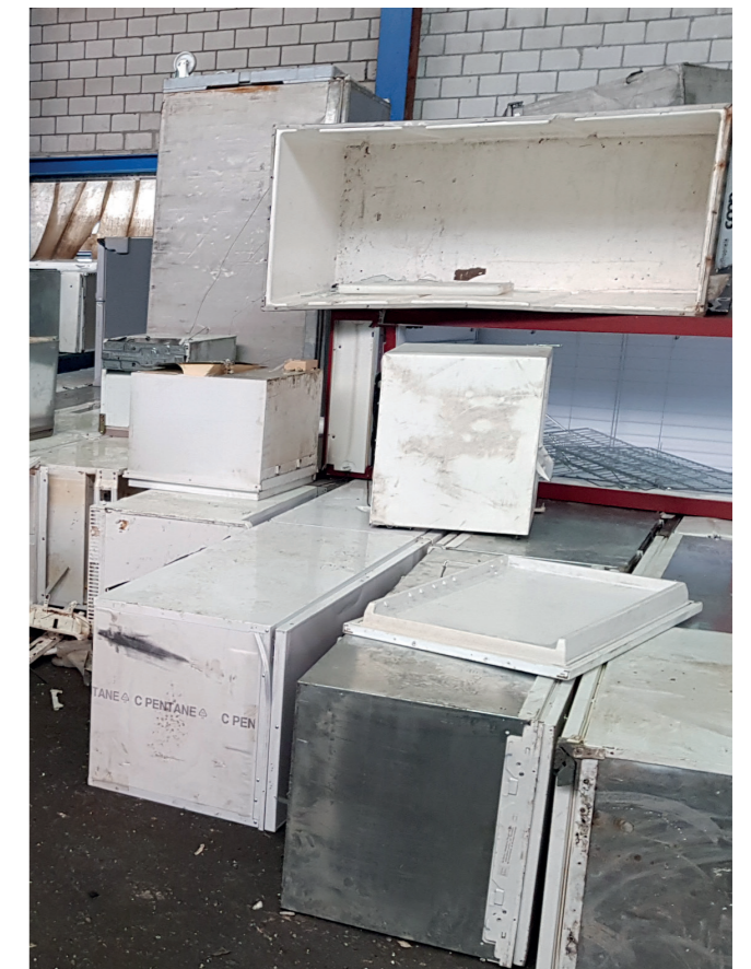
Photo 2: appareils de réfrigération avant le traitement de niveau 2 (broyage avec récupération des gaz propulseurs).
